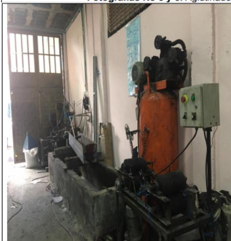
Fotografía No 7. Máquina extrusora 2.
