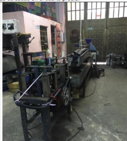
Fotografía No 8. Máquina extrusora 3.
